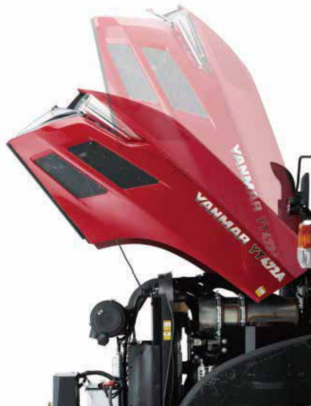
新型コア採用ラジエータ 様々な条件下でもオーバーヒートを防ぎます。
