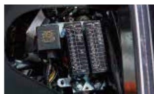
ヒューズボックス ヒューズの点検・交換が簡単にできます。
