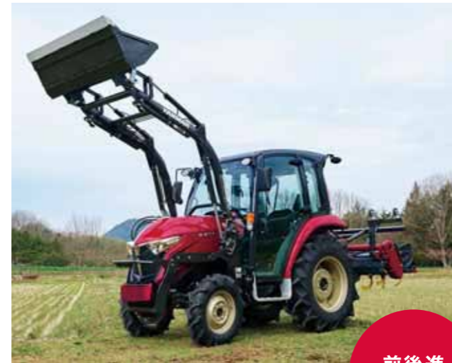
運搬作業 フロントローダー (三陽機器)
