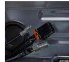
車速連動取出しカブラAG-PORTカブラ電源取出しカブラ
