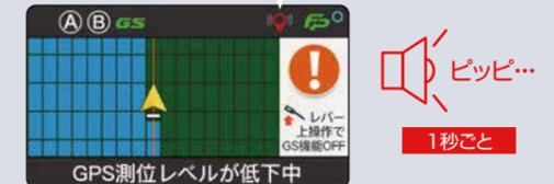
GPS位置情報の受信状態が低下すると、GSモニターの表示とブザーでお知らせします。
