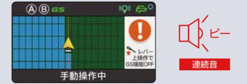
緊急時には直進アシスト走行中でも手動でハンドル操作が可能。その状況をGSモニターの表示とブザーでお知らせします。
