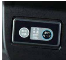
走行モード切換えスイッチ表示切換えスイッチ
