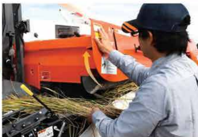
エンジン停止スイッチを押すと、エンジンが停止しレール台が開きます。
