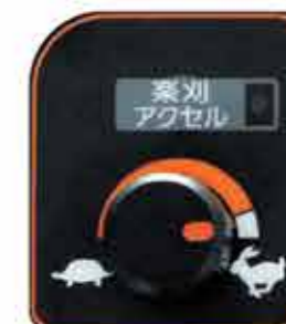
楽刈アクセルを「入」状態で、楽刈レバー、主変速レバーを操作すると、定格エンジン回転まで自動的に上昇。排出クラッチを操作するとダイヤル位置まで上昇。いずれの操作もしないときは、アイドリングとなります。
