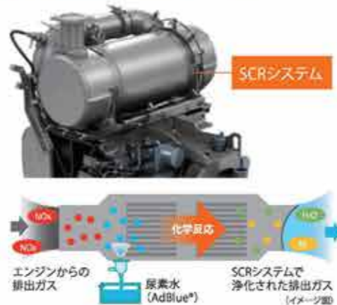
DPFを通過した排ガスに尿素水を噴霧することで窒素酸化物(NOx)を浄化し、大気中への窒素酸化物の排出を抑制します。
