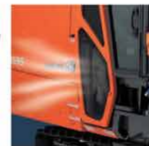
3分間に1回の割合で5秒間ラジエーターファンが逆回転することで、防塵網に付着したワラ屑やホコリを吹き飛ばします。また、ファンが大径化しました。
